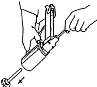
13302788 y el empujador 14402098 pueden ser facilmente sacados del cargador parte inferior y reemplazados.
