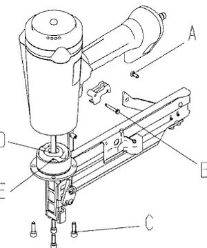
**Attention:** Couper l'appareil de l'alimentation en air comprimé et décharger le chargeur d'agrafes. La fixation du capuchon doit être effectuée à l'aide d'une clé dynamométrique, réglée à un couple de 14 Nm.
