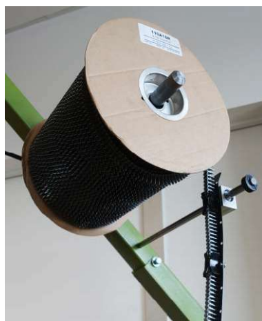
Fot. Szpula ze spinkami BIZON ST Roll oraz przewodnik spinek
