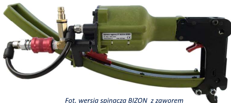
Fot. wersja spinacza BIZON z zaworem odblokowującym „BJR”
