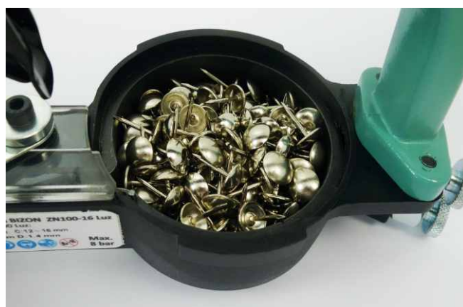
Fot. Odpowiednia ilość gwoździ ZN w magazynku wbijarki oraz właściwa regulacja dwóch strumieni powietrza zapewnia szybkie podawanie kolejnych gwoździ.
