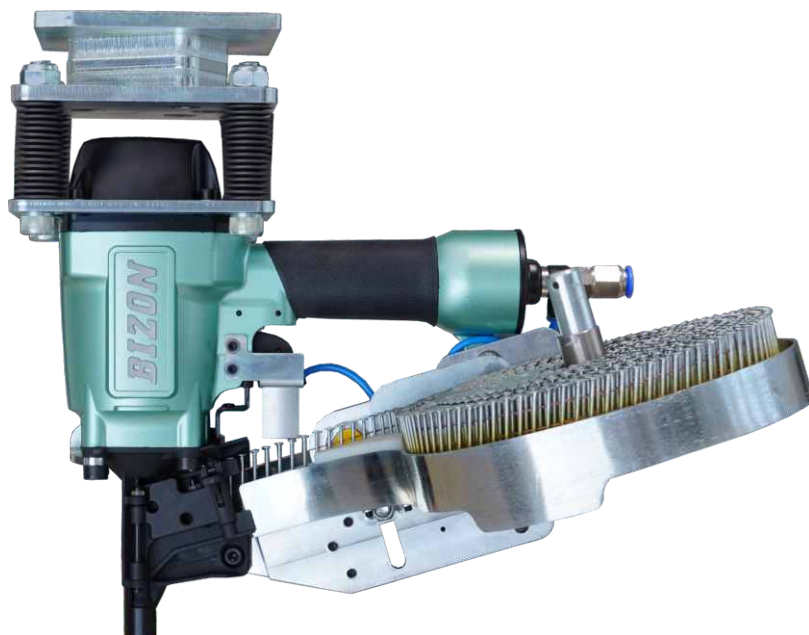
fot. gwoździarka BIZON 553 DC z magazynkiem JUMBO oraz uchwytem szybkiego mocowania na moście CNC
