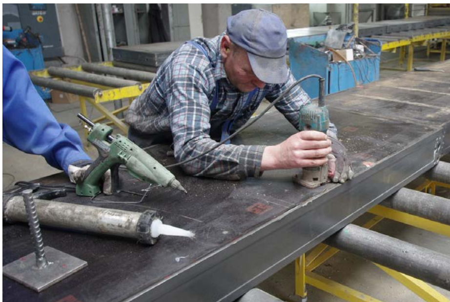
frezowanie ( widoczny na fot silikon służy do zalania ubytków (szczelin) na styku z ramą stalową
