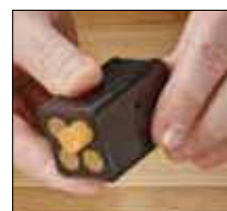
Forma do kleju profil silikonowy o średnicy wkładów kleju, do odzysku kleju z komory pistoletu
